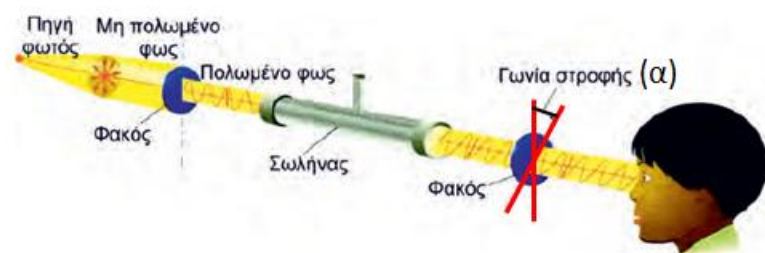
Σχήμα 3: Σχηματική παρουσίαση ενός πολωσίμετρου. Η οπτικά ενεργή ουσία στρέφει το επίπεδο του πολωμένου φωτός.
